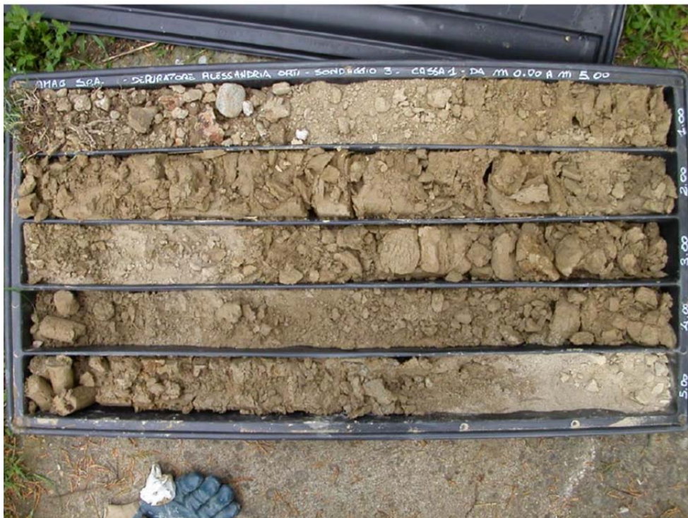
FIG. 5.11 - SONDAGGIO S3 – FOTO DELLA CASSETTA CATALOGATRICE DA 0 A 5 METRI DA P.C.
