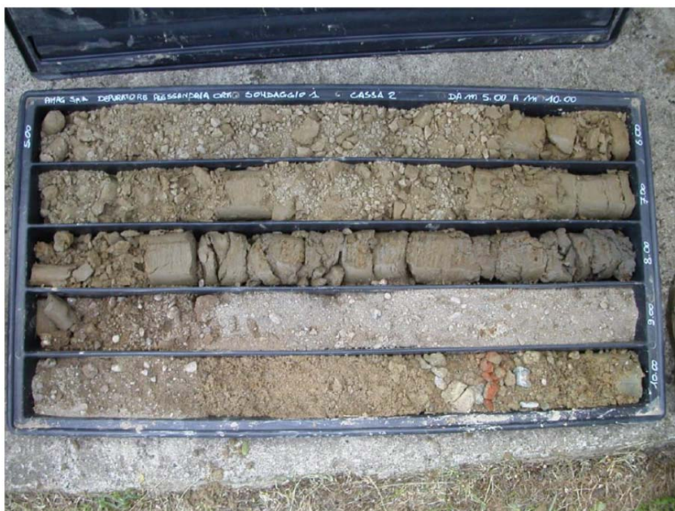
FIG. 5.4 - SONDAGGIO S1 – FOTO DELLA CASSETTA CATALOGATRICE DA 5 A 10 METRI DA P.C.
