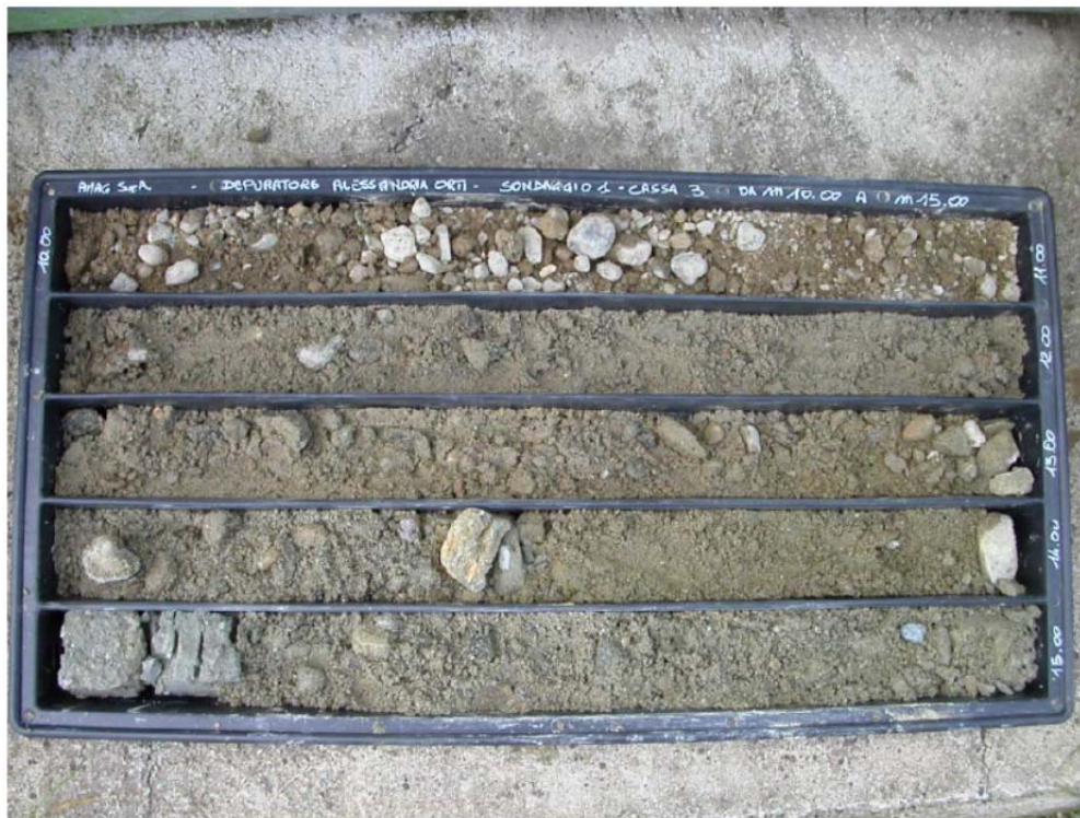
FIG. 5.5 - SONDAGGIO S1 – FOTO DELLA CASSETTA CATALOGATRICE DA 10 A 15 METRI DA P.C.
