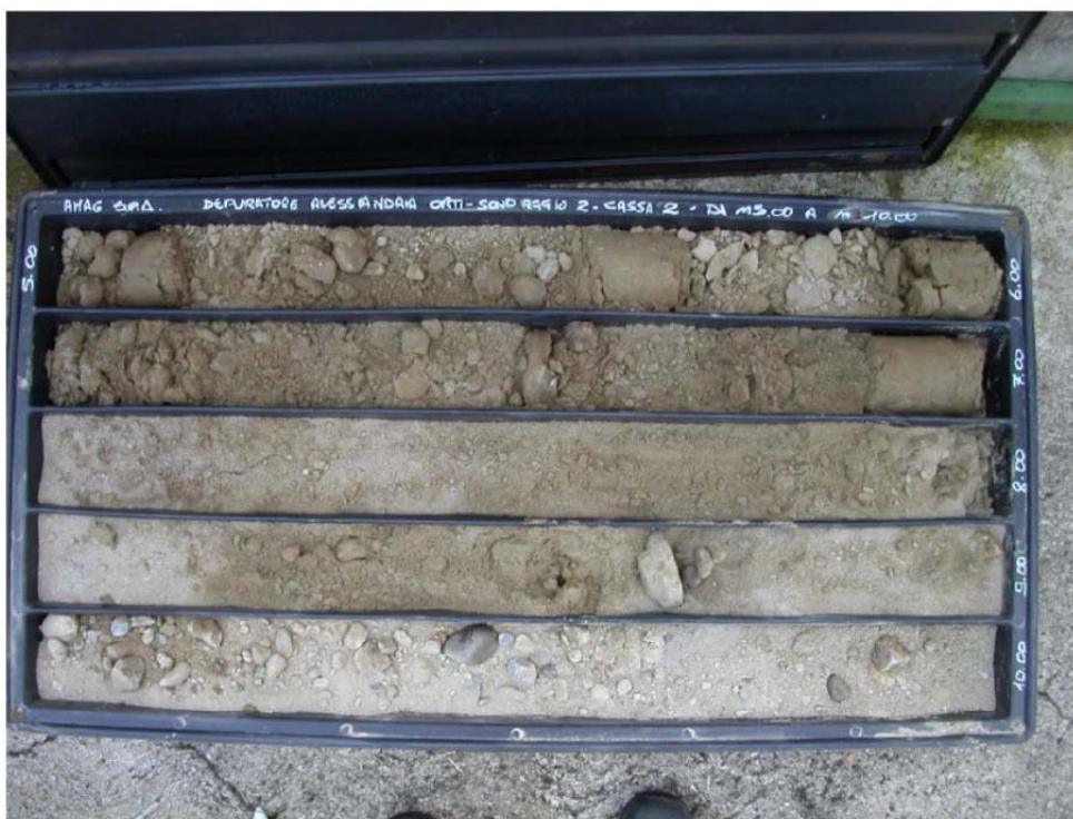
FIG. 5.8 - SONDAGGIO S2 – FOTO DELLA CASSETTA CATALOGATRICE DA 5 A 10 METRI DA P.C.
