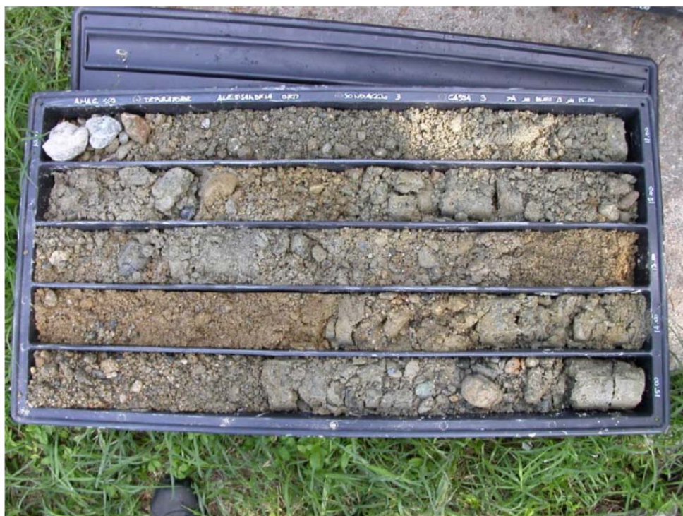
FIG. 5.13 - SONDAGGIO S3 – FOTO DELLA CASSETTA CATALOGATRICE DA 10 A 15 METRI DA P.C.
