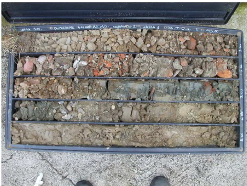
FIG. 5.7 - SONDAGGIO S2 – FOTO DELLA CASSETTA CATALOGATRICE DA 0 A 5 METRI DA P.C.
