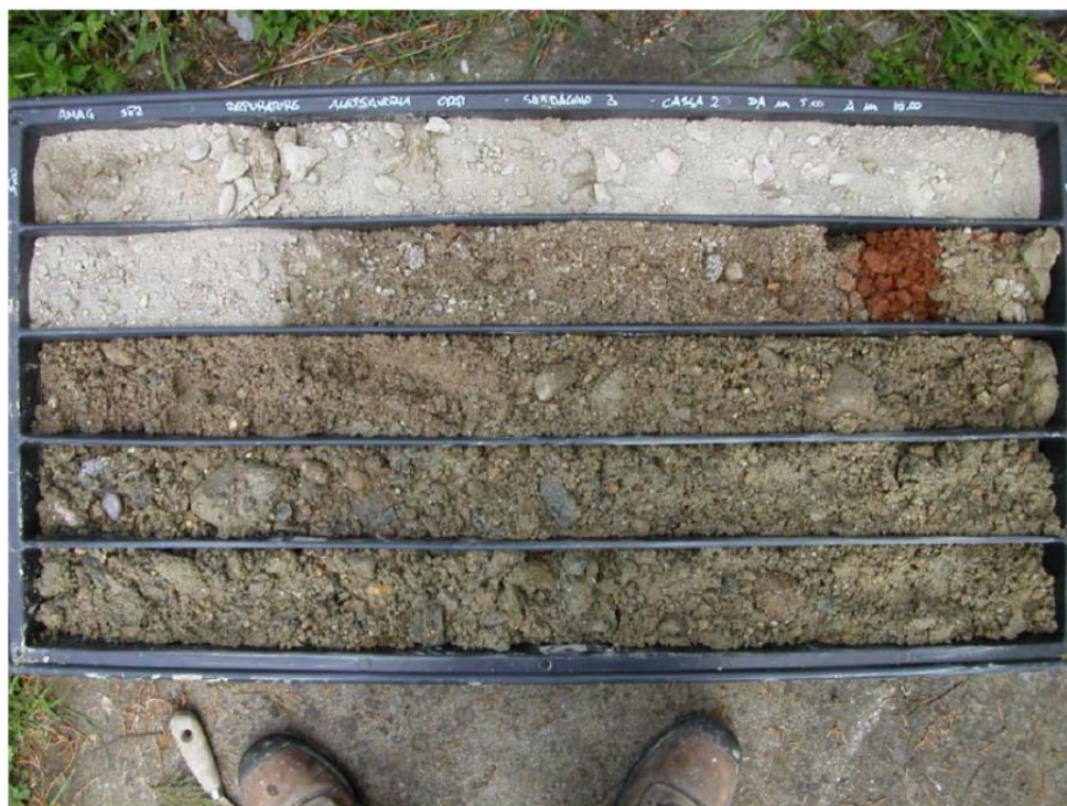
FIG. 5.12 - SONDAGGIO S3 – FOTO DELLA CASSETTA CATALOGATRICE DA 5 A 10 METRI DA P.C.
