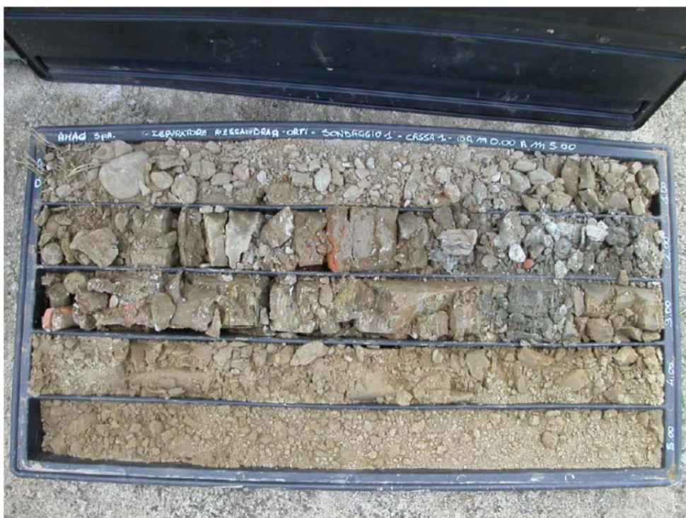
FIG. 5.3 - SONDAGGIO S1 – FOTO DELLA CASSETTA CATALOGATRICE DA 0 A 5 METRI DA P.C.
